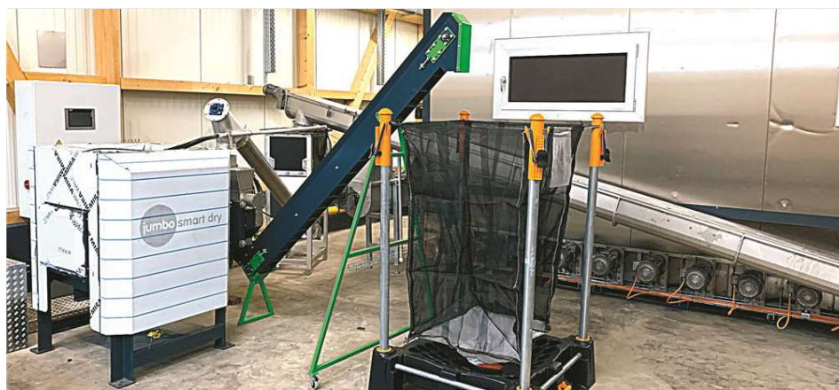
In dieser Anlage verwandelt sich nasse Biomasse in staubfreie Pellets.
